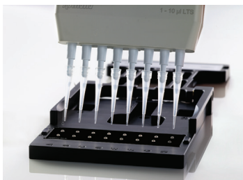
Figura 2. Use a placa de microvolumes Take3 Agilent BioTek com o espectrofotômetro de microplacas Epoch 2 Agilent BioTek para a quantificação direta de ácido nucleico e proteína em múltiplas amostras de 2 \mu L.
